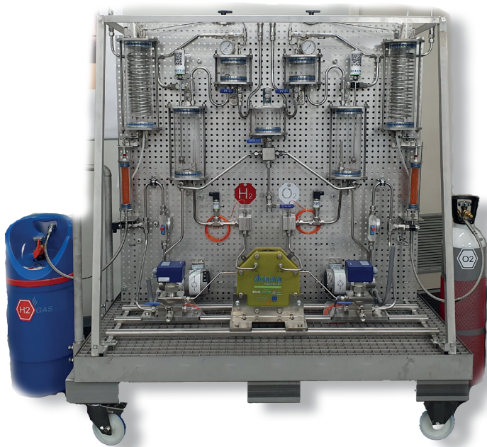
Den mobile «Hydrogenvognen» viser i detalj hvordan elektrolyseren virker.
